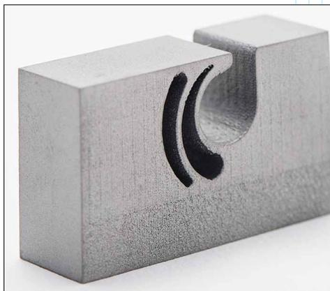
*Материалы с низкой вязкостью, такие как полиуретан, сложно использовать как уплотнитель между стальными деталями, а резиновые уплотнители очень подвержены износу. 3D-печать делает возможным создание эластичных функциональных элементов прямо по линии разреза. (Фотография предоставлена компанией Hofmann)*
