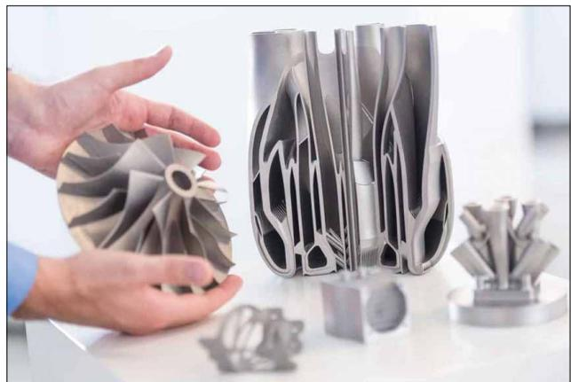
3D-принтеры *TruPrint* от *TRUMPF*, использующие технологию лазерного наплавления металлического порошка (*Laser Metal Fusion, LMF*), позволяют производить сложные металлические детали. (Фотография предоставлена компанией *TRUMPF*)
